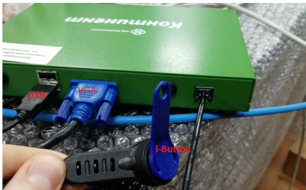
Рис. 1 - Подключение i-Button, VGA и usb- клавиатуры
